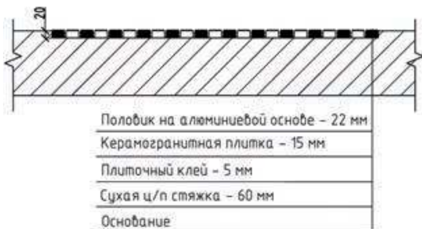
Рис. 19 – Схема монтажа половика в приямок глубиной 20мм.
