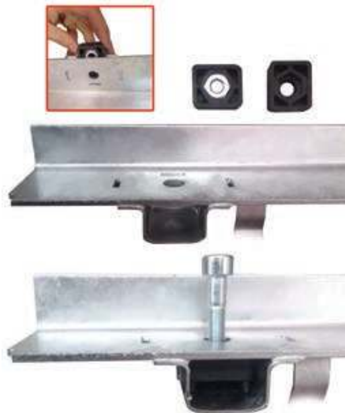
Рис. 1. Сменный резьбовой блок - плавающий самоустанавливающийся блок крепления со сменной гайкой фиксации
