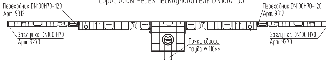
Схема линейного водоотвода при помощи двустороннего каскада лотков "AQUASTOK" DN100. Сброс воды через два пескоуловителя DN100/150.
