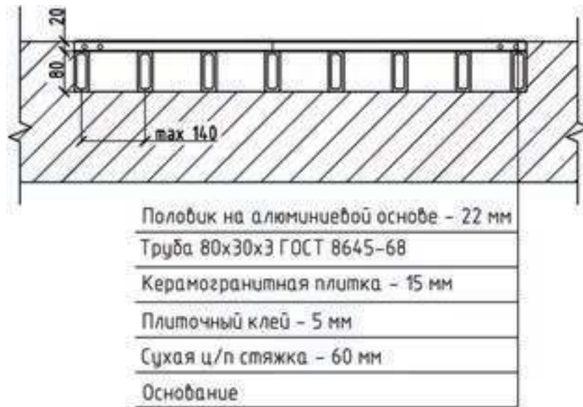
Рис. 18 – Схема монтажа половика в приямок глубиной 100 мм.
