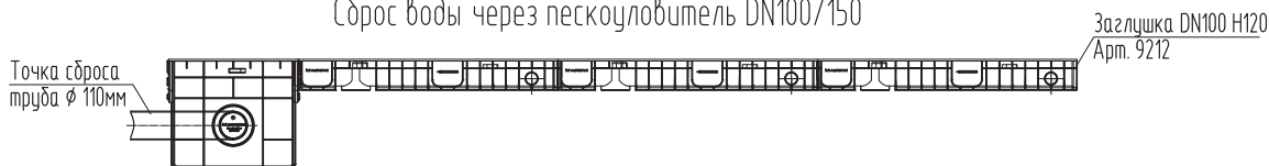
Схема линейного водоотвода при помощи каскадов лотков "AQUASTOK" DN100 H70-H120-H180
