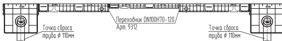
Схема линейного водоотвода при помощи двойного каскада лотков "AQUASTOK" DN100.
